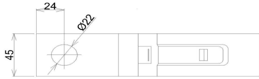
H200用固定金具 (材質SUS301, 板厚: 1.5mm)
